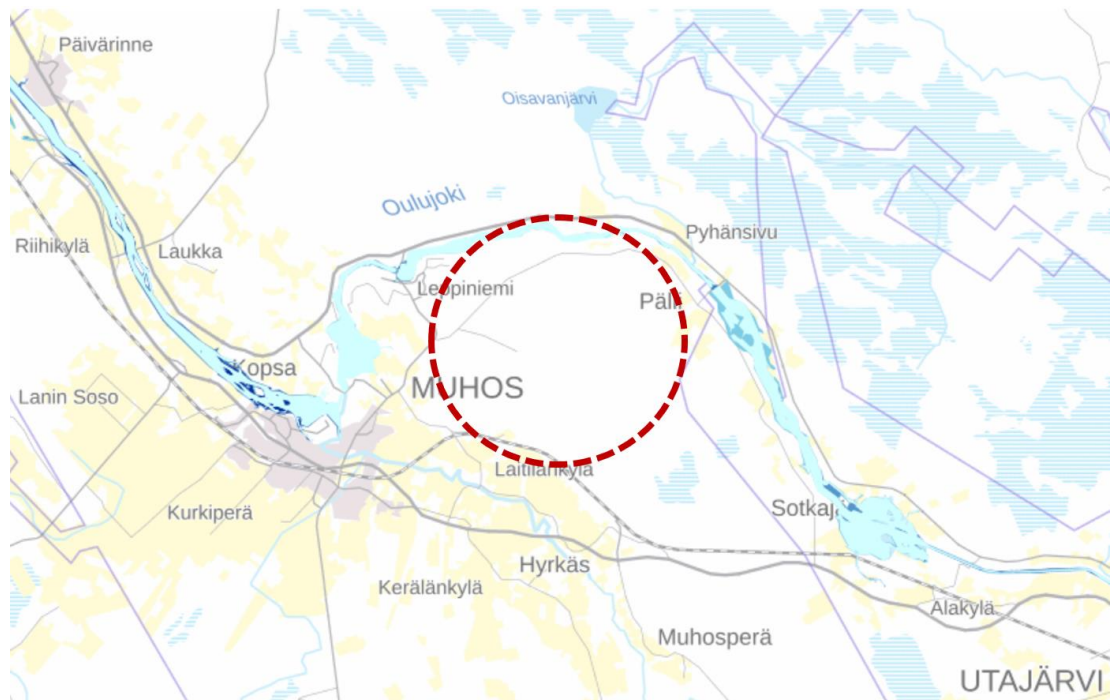
Kuva 7. Suomen ympäristökeskuksen tulvavaaravyöhykekarttojen mukaan vesistötulvat eivät aiheuta tulvariskiä alueella. Kuvassa esitetty 1/250 a tulva (SYKEN avoimet paikkatietoaineistot ja MML peruskartta, 2024). Mahdollisten vesistötulvien lisäksi alueella tulee varautua myös mahdollisiin pato-onnettomuustilanteisiin.
